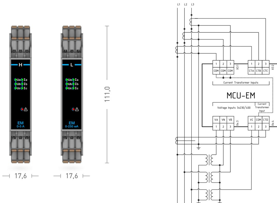
В составе щитов распределения электрической энергии и в автоматизированных системах диспетчерского контроля и технического учета энергоресурсов модули MCU-EM обеспечивают оперативный контроль:
